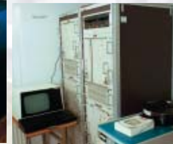
Herover: CR80 anlæg med tilhørende harddisk til bl.a. Delta Air og American Airlines (billetkontrol) fra Christian Rovsing A/S.
